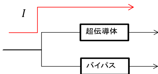
図 1.3 平常時 ( I \leq I_c ) のときの動作
