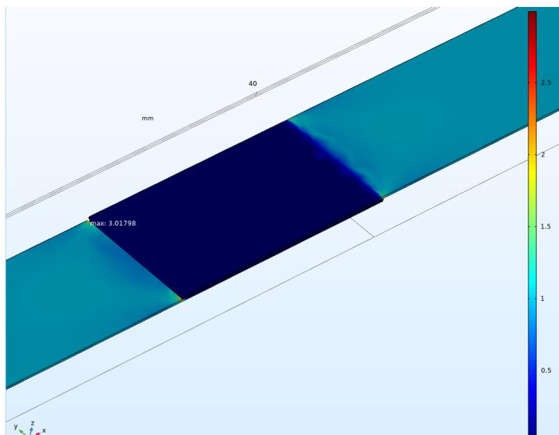
図 3.15 四角形接合の応力分布(横に引っ張る力)
