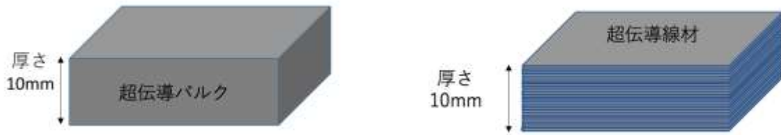
図 3.4 超伝導バルクと超伝導線材の反発力の比較方法
