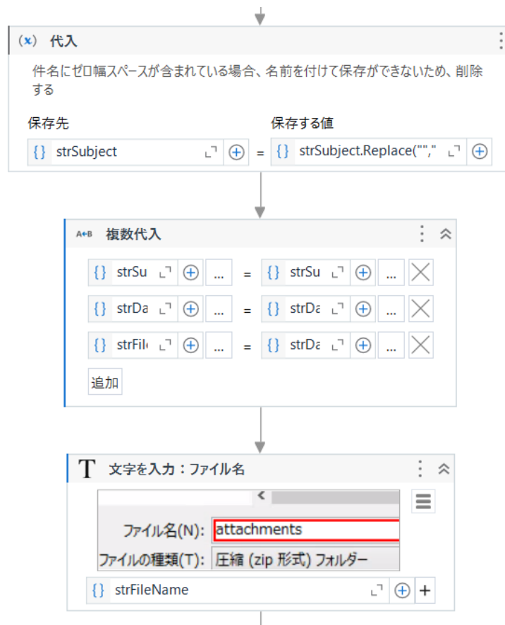
図 3.4: UiPath Studio による数値処理と画像認識を用いた文字入力
